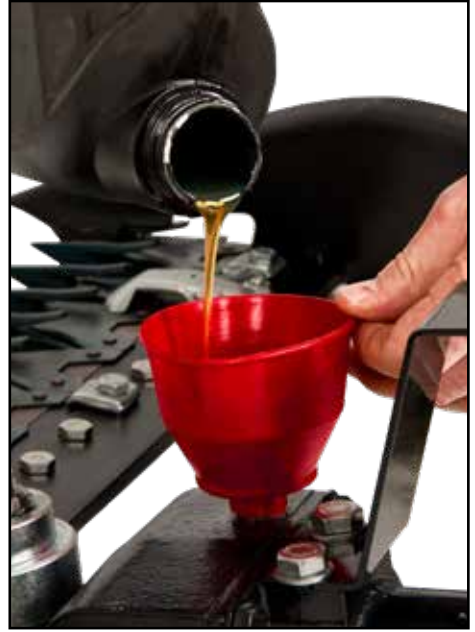
Fig. 8 - Kutu yağ doldurma ve boşaltma tapası ve mafsals yağlayıcı
