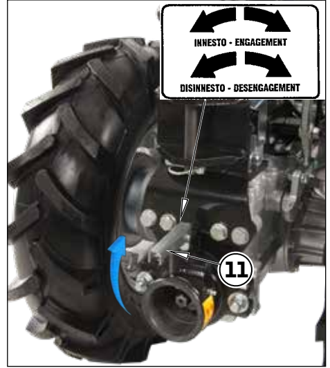
Fig. 5 - Ekipmanları PTO'ya çabuk bağlamak için QUICK KAPLİN.
