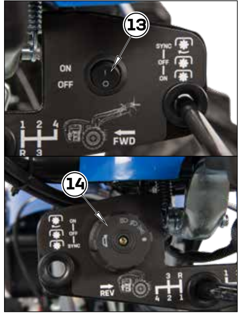
Fig. 7 - Paneldeki kontroller ve ekipmanlar (3LD-510 ve 2LA-490 motorlu versiyonlar)
