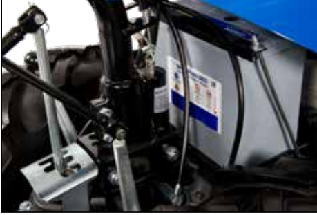
Fig. 1 - Gidon kolu sütunun altına sabitlenmiş, el traktörünün numarası ve tipini gösteren seri numarası etiketi
